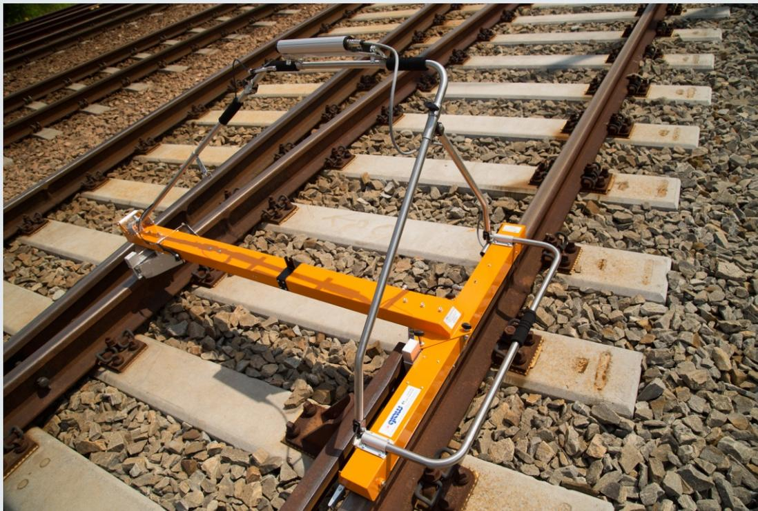
Le chariot mesure la géométrie de la voie, des aiguillages, et consigne les inspections visuelles faites par l'opérateur. Le chariot est facile à utiliser et sa conception modulaire permet son transport par une personne et sa mise en place s'effectue en moins de 5 minutes.
