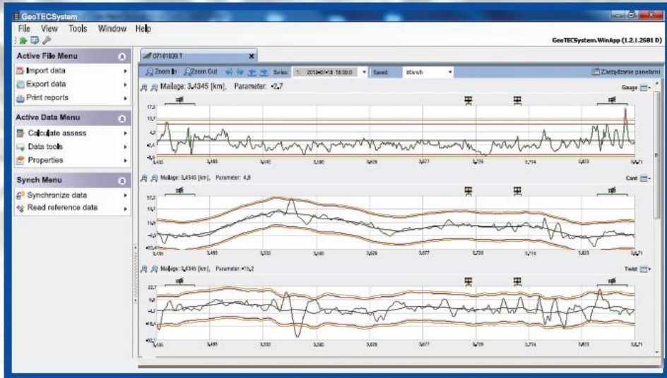
Copie de l'écran du logiciel PC d'analyse et de présentation des résultats de mesure, fourni avec la règle d'écartement.
